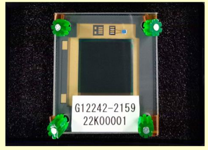
試作した大フォーマットセンサ 受光部: 19.52×19.52mm
