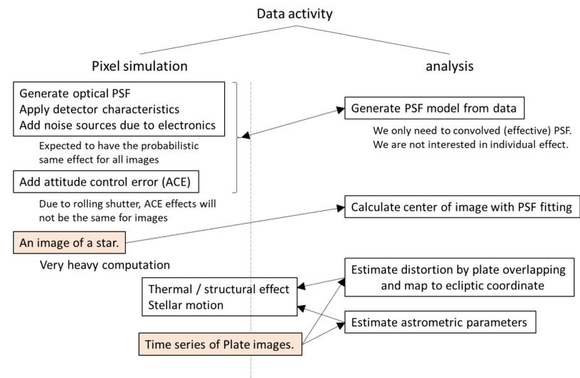
JASMINEが目指すのは、我々の天の川銀河の中心付近でのAstrometryです。距離はおよそ8kpc、年周視差は125 $\mu$ 秒角( $6 \times 10^{-10}$ rad)、距離の議論をするには年周視差を相対誤差20%程度の精度で測定する必要がありますので、25 $\mu$ 秒角( $\sim 10^{-10}$ rad)精度の測定が必要です。このレベルでは、観測装置の様々な擾乱や特性変化がノイズ要因となりますが、これらはこの精度で測定しつつ補正することは不可能です。そこで、擾乱や変化を「モデル化」して、そのモデルのパラメータを求めたい星の運動パラメータと同時に推定します。星の運動は測定装置より正確なので、運動する星の位置そのものを基準にすることが出来ます。擾乱モデルは、知見が更新されてゆくこともあるので、モデルの変更に対して柔軟なソフトウェアを構築する必要があります。
